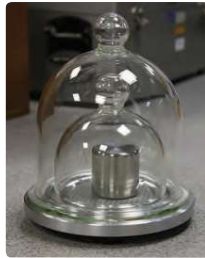
شکل ۱-۱ استاندارد ملی کیلوگرم که نسخه دقیقی از استاندارد بین‌المللی سیور فرانسه است. این نمونه، در مرکز اندازه‌شناسی در سازمان ملی استاندارد ایران نگهداری می‌شود.
